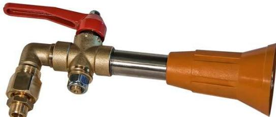
Getto completo di ugello con foro 1,5 e raccordo girevole G. 1/4" M., con una pressione massima di esercizio pari a 50 bar, utilizzabile per i trattamenti antiparassitari di colture a medio e alto fusto.
