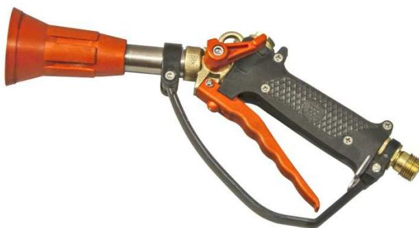
Pistola completa di ugello con foro 1,5, raccordo girevole G.  $\frac{1}{2}$ " M. e protezione, con una pressione massima di esercizio pari a 50 bar, utilizzabile per i trattamenti antiparassitari di vigneti e frutteti.
