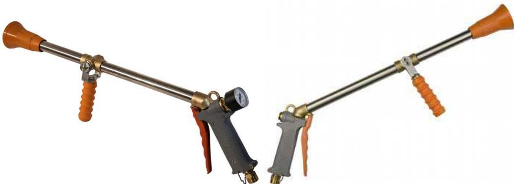
Lancia completa di ugello con foro 2,5 e raccordo girevole G.  $\frac{1}{2}$ " M., con una pressione massima di esercizio pari a 50 bar, utilizzabile per i trattamenti antiparassitari di colture a medio ed alto fusto.
