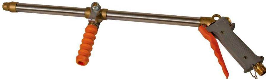
Lancia completa di ugello con foro 2,5 e raccordo girevole G.  $\frac{1}{2}$ " M., con una pressione massima di esercizio pari a 50 bar, utilizzabile per i trattamenti antiparassitari di colture a medio ed alto fusto.
