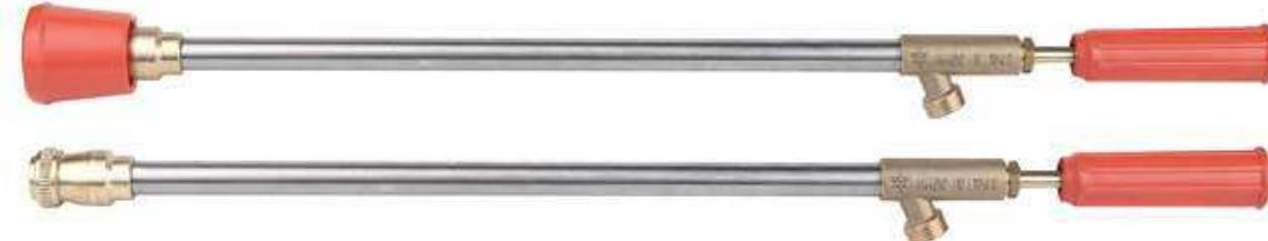
Lancia completa di piastrina ceramica Ø 15, foro 1,5, con una pressione massima di esercizio pari a 40 bar, utilizzabile per i trattamenti antiparassitari di alberi a medio fusto.
