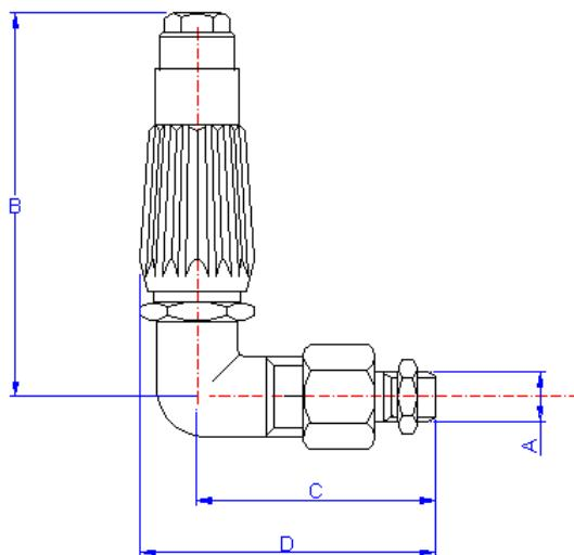
Boquilla completa de boquilla cónica Ø 1,5, con una máxima presión de esfuerzo de 50 bar; empleada con grupos rociadores para viñedos y cultivos de frutas.
