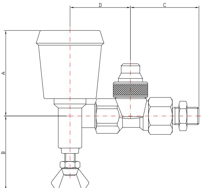
Boquilla completa de protección Turbo con boquilla en cerámica Ø 15, agujero 1,2 y una máxima presión de esfuerzo de 50 bar; empleada con grupos rociadores para viñedos y cultivos de frutas.
