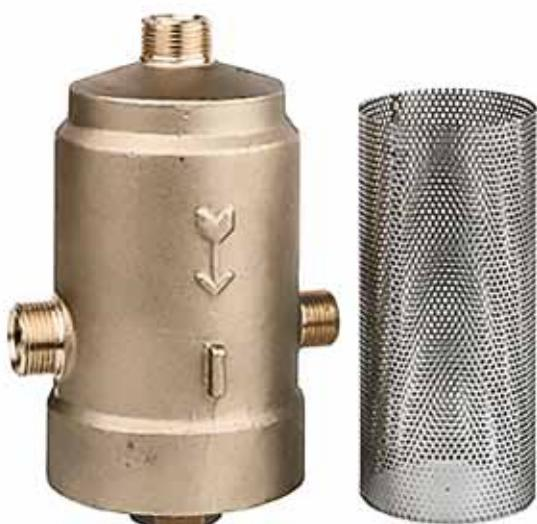
Filtro completo di cartuccia inox Ø 1, G.  $\frac{1}{2}$ " M. x G.  $\frac{3}{4}$ " M. x G.  $\frac{3}{4}$ " M., con una pressione massima di esercizio pari a 50 bar; utilizzabile su atomizzatori.
