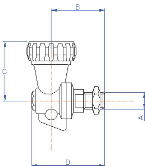
Boquilla completa de tuerca anular, contratuerca y boquilla, con una máxima presión de esfuerzo de 40 bar; empleada con atomizadores.
