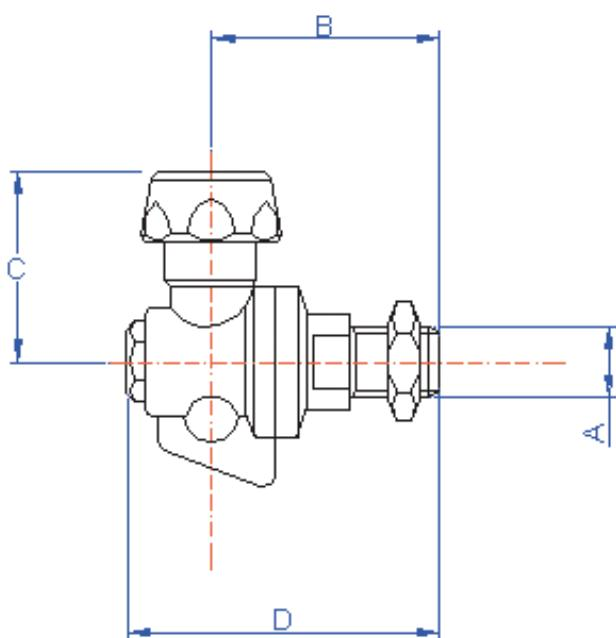
Boquilla completa de tuerca anular, contratuerca y boquilla, con una máxima presión de esfuerzo de 40 bar, empleada con atomizadores.
