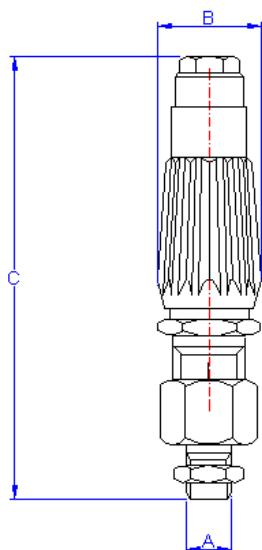
Boquilla completa de boquilla cónica Ø 1,5, con una máxima presión de esfuerzo de 50 bar; empleada con grupos rociadores para viñedos y cultivos de frutas.
