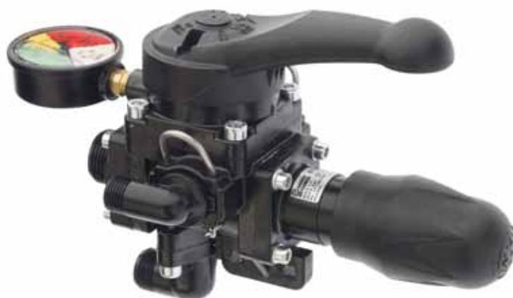
Gruppo comando con valvola di regolazione pressione lavoro, leva unica per comando chiusura parziale e scarico. manometro alla glicerina con quadrante colorato. Portata max 200 l/min e pressione max 50 bar.
