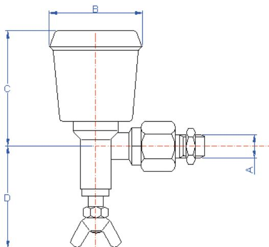
Boquilla completa de protección Turbo con boquilla en cerámica Ø 15, agujero 1,2 y una máxima presión de esfuerzo de 50 bar; empleada con grupos rociadores para viñedos y cultivos de frutas.
