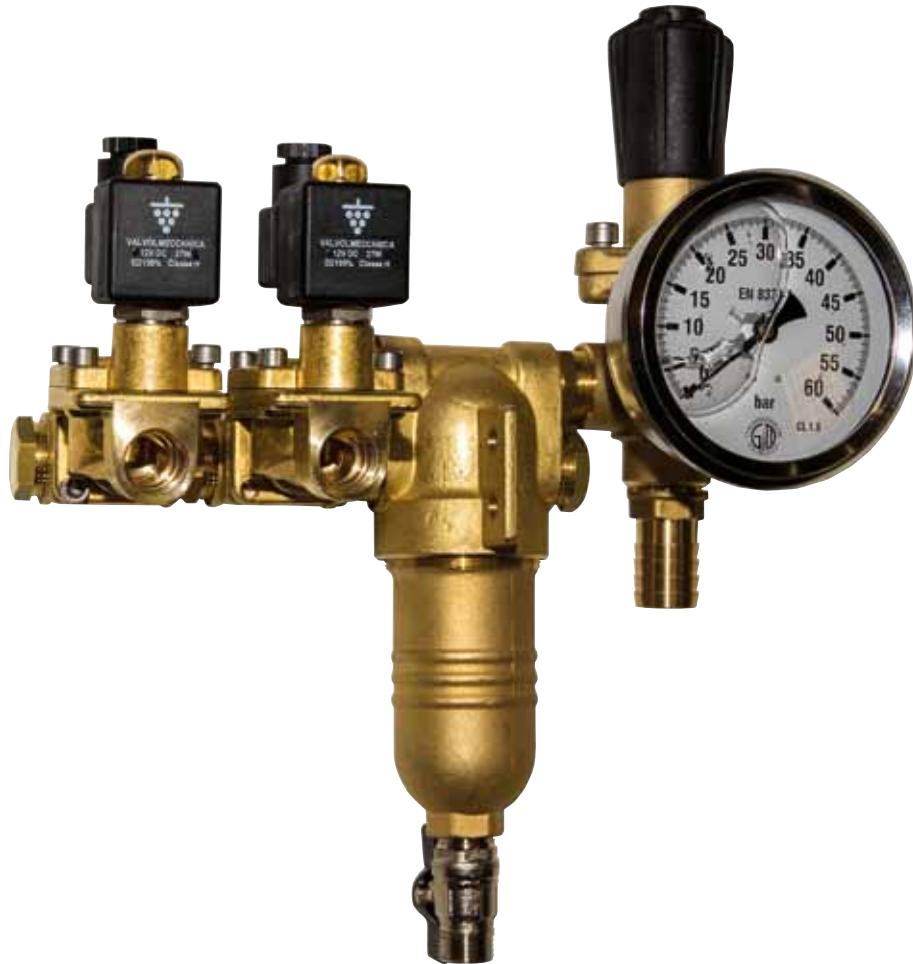
Gruppo completo di elettrovalvole a solenoide, filtro di mandata 150 l/min., valvola volumetrica e manometro.
