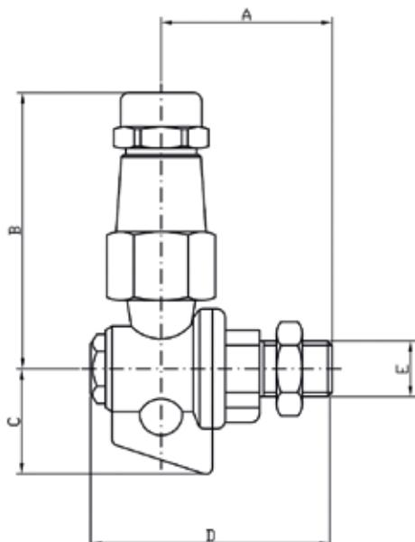
Getto completo di ghiera, controdado e ugello, con una pressione massima di esercizio pari a 40 bar; utilizzabile su atomizzatori.
