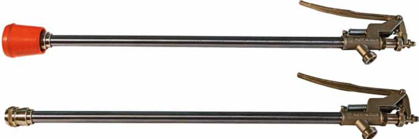
Lancia completa di piastrina ceramica Ø 15, foro 1,5, con una pressione massima di esercizio pari a 40 bar; utilizzabile per i trattamenti antiparassitari di alberi a medio fusto.
