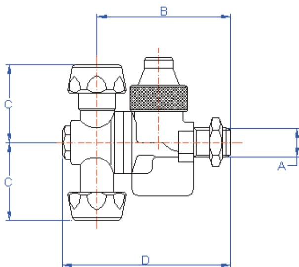
Boquilla completa de tuercas anulares, contratuerca y boquillas, con una máxima presión de esfuerzo de 40 bar, empleada con atomizadores.
