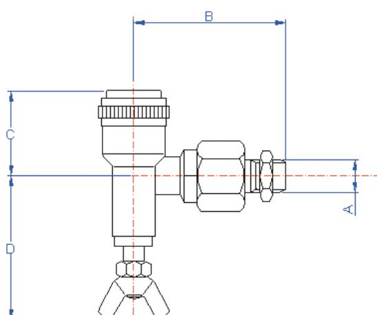
Boquilla completa de tuerca de latón con boquilla en cerámica Ø 15, agujero 1,2 y una máxima presión de esfuerzo de 50 bar; empleada con grupos rociadores para viñedos y cultivos de frutas.
