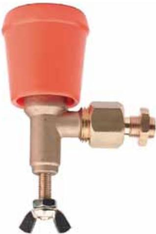
Getto completo di protezione Turbo con ugello in ceramica Ø 15, foro 1,2 e con pressione massima d'esercizio di 50 bar, utilizzabile su gruppi irroranti per vigneti e frutteti.
