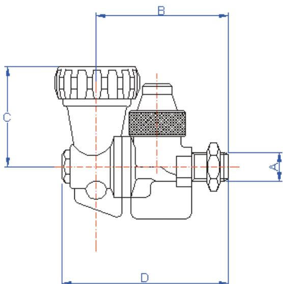
Boquilla completa de tuerca anular, contratuerca y boquilla, con una máxima presión de esfuerzo de 40 bar; empleada con atomizadores.
