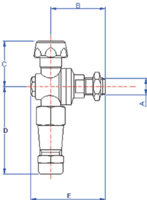
Getto completo di ghiere, controdado e ugelli con una pressione massima di esercizio pari a 40 bar, utilizzabile su atomizzatori.
